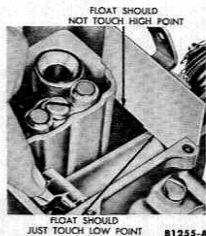
FIG. 20—Float Setting
